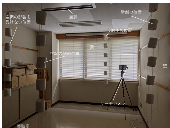
図 7: 時定数同定実験の様子
